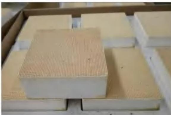
催化剂以堇青石蜂窝陶瓷为载体，以稀土材料作为催化剂的助催化活性组分，以少量的Pd、Pt等贵金属作为主催化活性组份。要求产品稳定，气流阻力小，净化效率高，耐高温冲击，使用寿命长。
