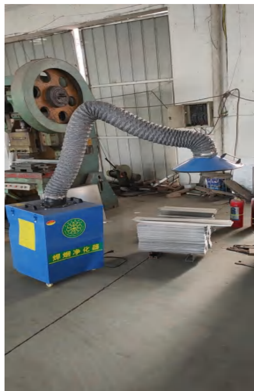
焊烟处理设施
